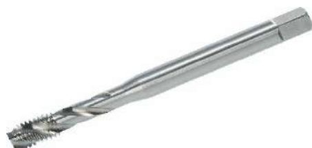
Völkel Maschinengewindebohrer Form C/35°RSP für metrisches ISO-Gewinde - DIN 371 - HSS-E ab M12 nach DIN 376 - alle für Sacklöcher
