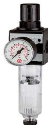
Riegler Filterregler »multifix«, PC-Behälter, BG 1, G 1/4 Einstellbereich von 0,5-10 bar - vordruckunabhängiger, rücksteuerbarer Membrandruckregler mit Sekundärentlüftung in Kombination mit einem Zentrifugalabscheider
