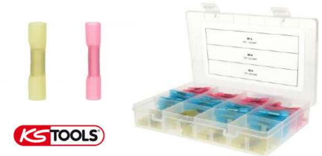
KS-Tools Schrumpfstößverbinder, 0,5 mm 2 - 6,0 mm 2 , 200-tlg geeignet für Kabelquerschnitte: rot 0,5 - 1,5 mm 2 , blau 1,5 - 2,5 mm 2 , gelb 4,0 - 6,0 mm 2
