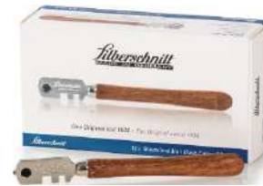
Silberschnitt Glasschneider für Glasdicken von 3 - 6 mm mit 6 Schneidrädchen, aus Edelstahl mit Spezialhärtung und mit flachem Holzheft - Linealabstand 2,5 mm.
