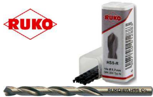
Ruko Spiralbohrer nach DIN 338 HSS-Co rechtsschneidend Spitzenwinkel 118° · ab Ø 3mm mit Kreuzanschliff Ausführung als 10er bzw. 5er Packung
