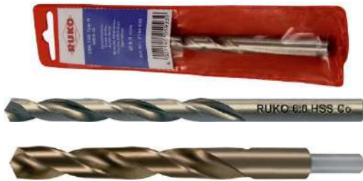
Ruko Spiralbohrer nach DIN 338 HSS-Co rechtsschneidend Spitzenwinkel 118° · ab Ø 3mm mit Kreuzanschliff Ausführung als Einzelverpackung ab 13,5mm mit abgesetzter Schaft
