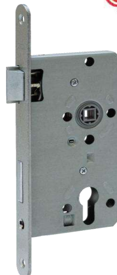
Einsteckschloss " ES PZ2 " für Wohnungsabschlusstüren Dornmaß: 55mm x Entfernung: 72mm Stulp 20 x 235mm rund silber - für Profilzylinder Riegel und Falle aus Metall
