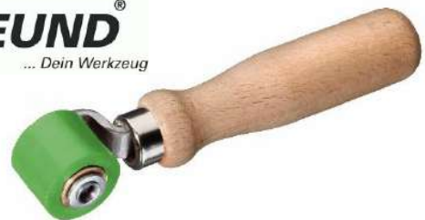
Freund Andrückrolle Silikon, Silikonrolle, Kugellager, Achse vernietet, ergonomischer Naturholzgriff für maximalen Druck, Bügel einseitig, für Überlappschweißungen
