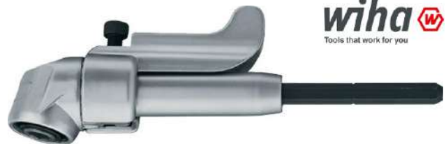
Wiha Winkelschraubvorsatz 1/4 Zoll Drehmom.max.14 Nm 400min -1 - mit abgewinkeltem Kopf (105°) · für den Einsatz im konv. Akkuschrauber · Stahlgehäuse · für Bits C 6,3 und E 6,3
