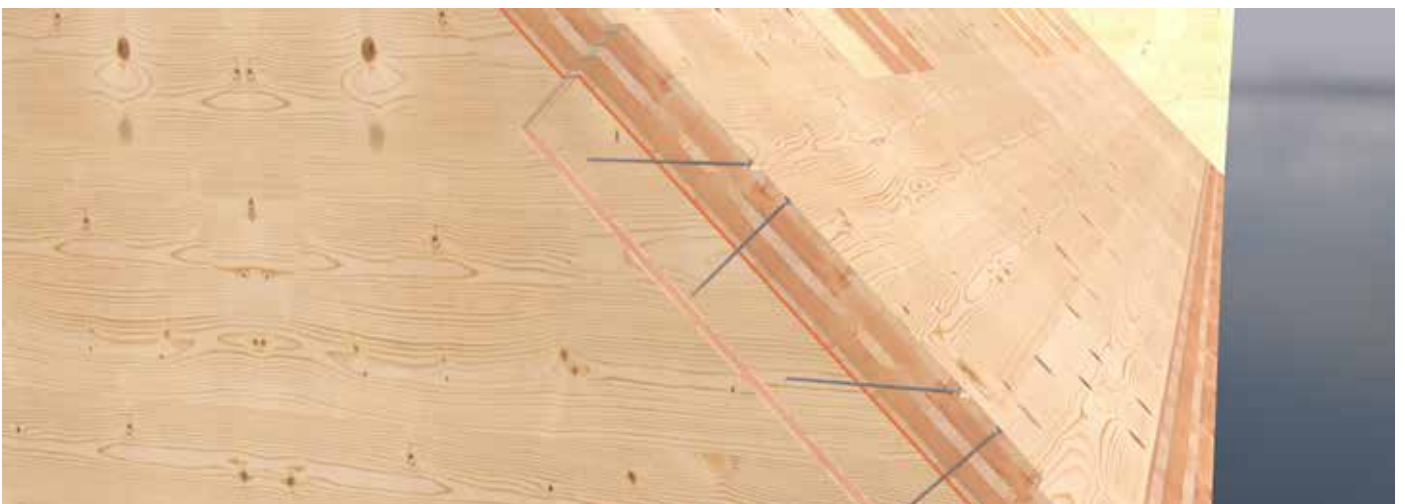
Verbindung von Dach- und Wandelement
