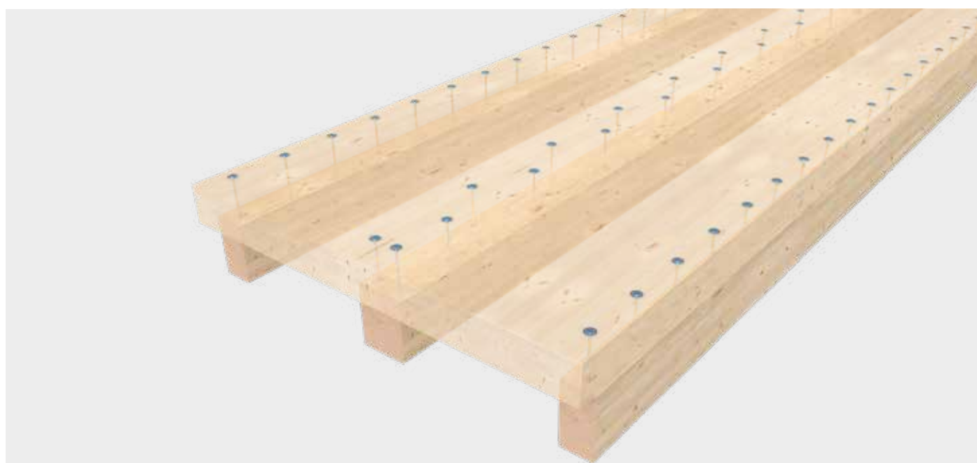
Pressdruckverteilung bei der Schraubenpressklebung von Holzrippenelementen
