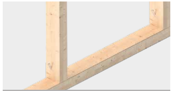
Befestigung von Stützen bei Holzrahmenkonstruktionen im Fußschwellenbereich
